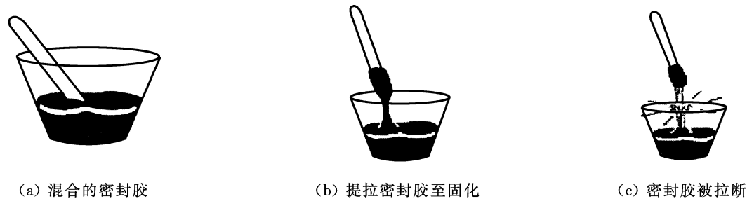
图 D.4 拉断时间试验
